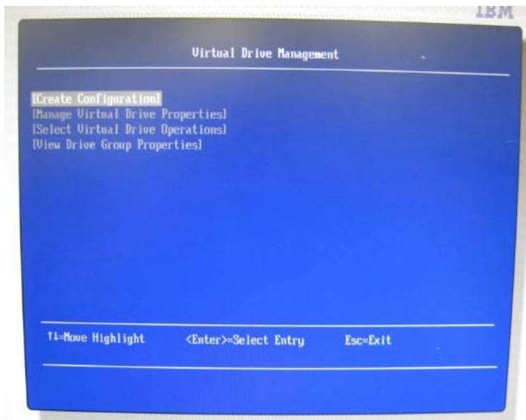
4. 选择 Create Configuration，在 Select RAID Level 里选择 RAID 级别，ServeRaid C100 可以支持 RAID0 和 RAID1，示例中选择配置 RAID1。
