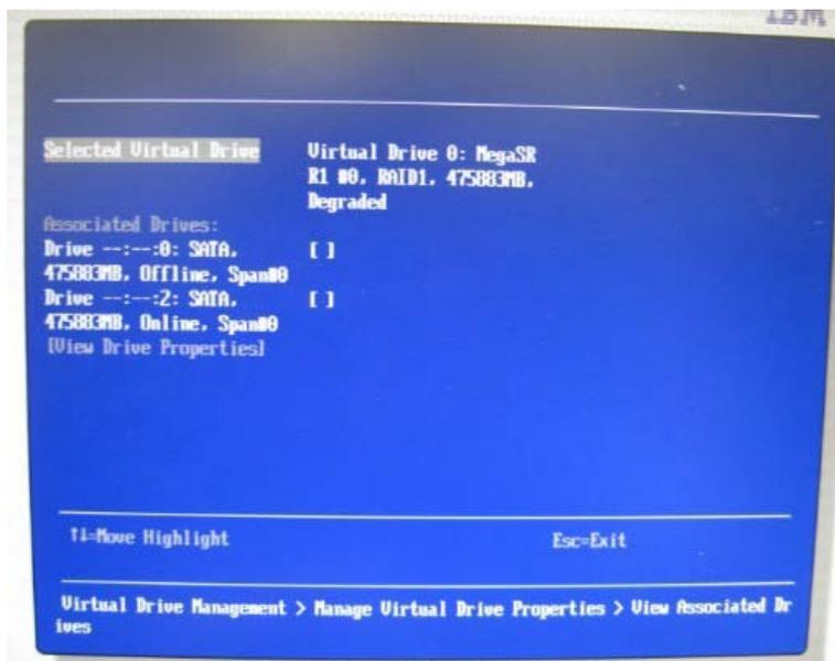
3.选择 Drive Management->Select Drive Operations 界面中选择 Offline 的 Drive0, 在 Drive Operation 中选择 Rebuild, 选择 Start Operation 开始阵列重建(Rebuild)操作
